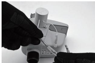
コントローラーのオス端子とセンサーのメス端子を奥まで差し込みます。
