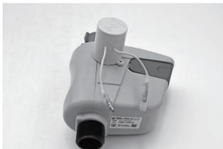
専用コントローラーのギボシ端子を外します。
