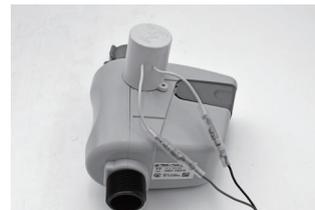
差し込んで完了です。ギボシ端子に防水テープなどを付けないようにして下さい。冬季に取り外した場合は専用コントローラーの端子をループ接続にします。
