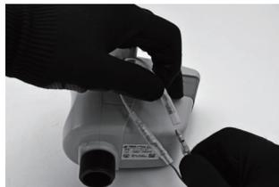
コントローラーのメス端子とセンサーのオス端子を奥まで差し込みます。
