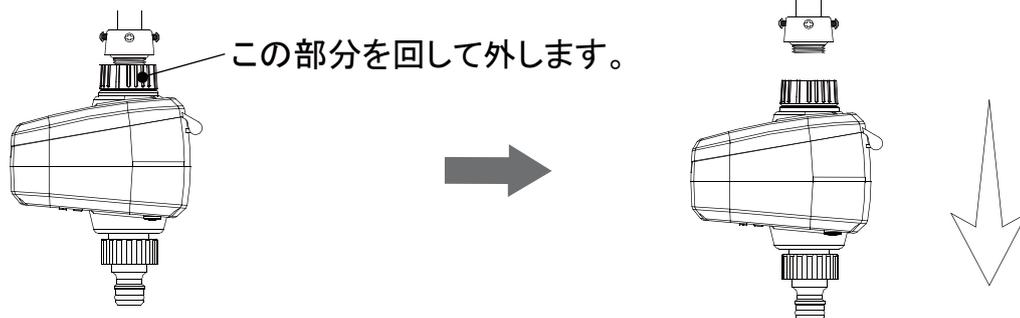
5：コントローラーを逆さまにして、数回降って内部の水を抜きます。
