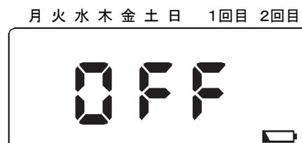
電池が消耗すると右下に電池のマークが表示され、散水されなくなりますので、電池を交換して下さい。
