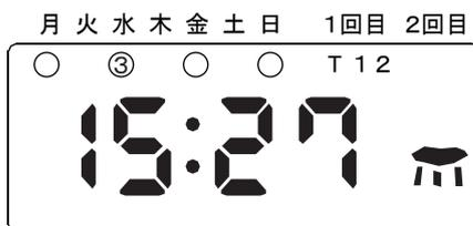
スイッチをセンサー作動にして、降雨がありセンサーが働いている場合は現在時刻と、雨雲のマーク表示され、自動散水は行われません。手動運転も出来ませんので、解除して下さい。（解除手順は17ページ参照）
